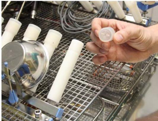
Verschiedene Anschlüsse für Hohlrauminstrumente
